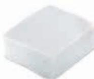
Grobschmutzfilter der Klasse G3 halten zum Schutz der Filterkassetten ca. 80 % der Staubpartikel > 10 µm (sichtbar) zurück. Die Filtermatte hat einen progressiven Tiefenaufbau! D. h. die Faserdichte ändert sich im Querschnitt. Die dichtere Filterseite zeigt zur Filterkassette.
