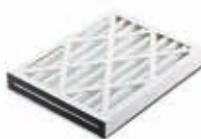
G4 Filterkassetten werden als Vorfilter zum Hauptfilter eingesetzt. G4 Filter halten 90 % der Staubpartikel > 10 µm zurück. Sie bestehen aus gefalteten Vliesstoffen und sind somit formstabil. Unterstützt wird die Formhaltigkeit bei hoher Beaufschlagung durch ein Drahtgeflecht. Gehalten wird das Filterelement durch einen Papprahmen mit flexibler Dichtung Turbinenseitig. Die G4 Filterkassette hat einen Luftwiderstand von nur 45 Pa.
