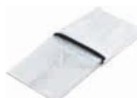
Türschleuse aus PP-Folie zum Anbringen an Zimmertüren. Schottet den Arbeitsbereich ab, dadurch läßt sich ein Unterdruck erzielen und es wird vermieden, dass sich Stäube außerhalb des Arbeitsbereiches ausbreiten.
