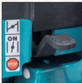
12. Touch&Stop sistem za upravljanje z eno ročico Ima točno določene položaje ročice za hladen zagon, delovanje in za zaustavitev naprave.
