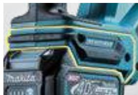
Ohišje je razdeljeno na zgornji in spodnji del ter povezano z gumenim podlogo za dušenje vibracij, ki zmanjšuje obremenitve akumulatorja in terminalov.
